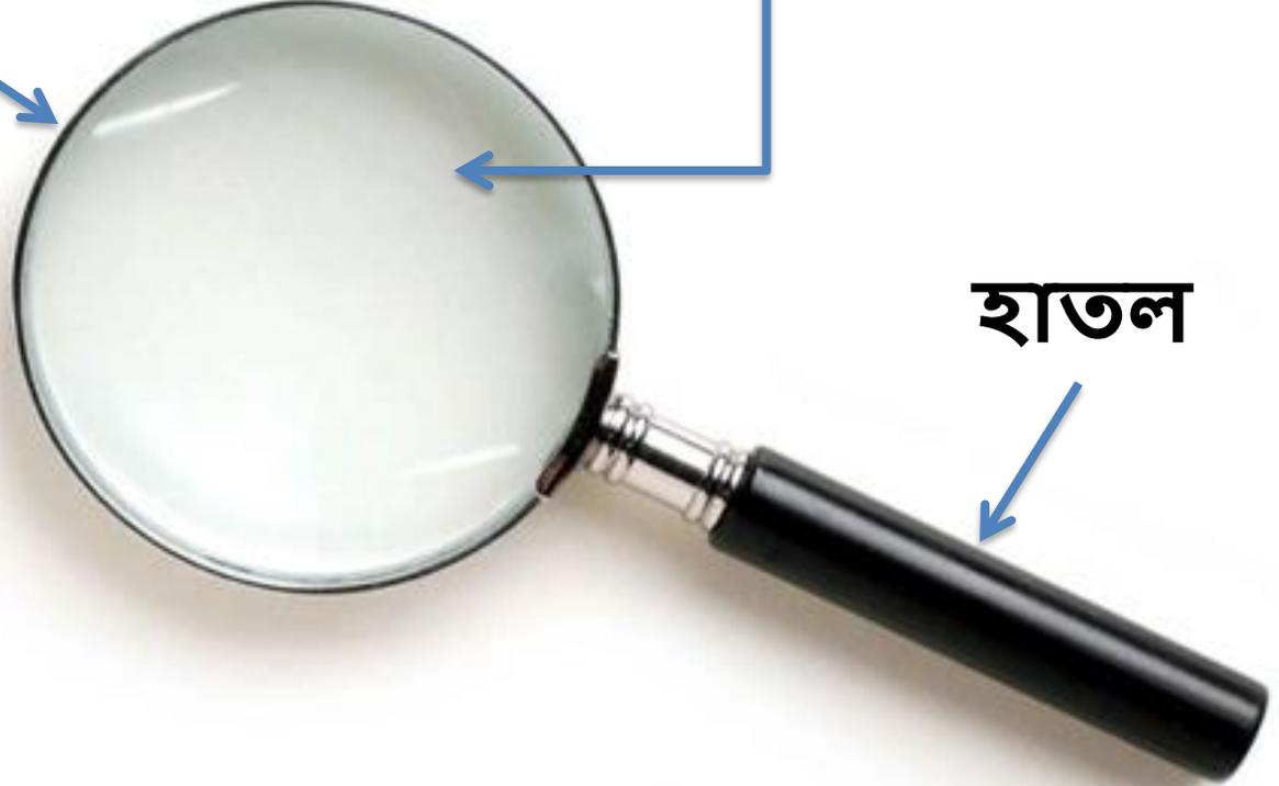
চিত্রঃ সরল অণুবীক্ষণ যন্ত্রের গঠন।
